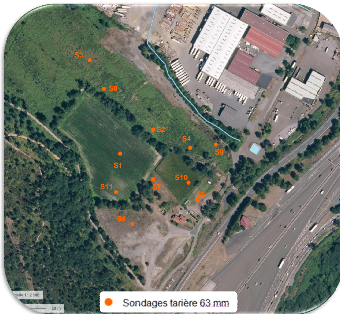
Figure 1 : Localisation des sondages
